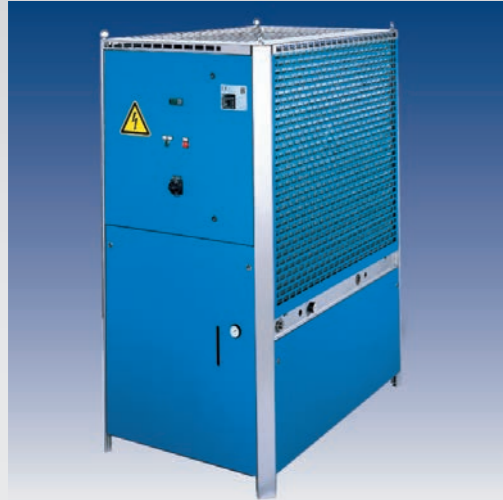
SVK - urządzenie do schładzania nagrzanej wody chłodzącej o wydajności chłodzenia od 15 do 130 kW, ze zbiornikiem i pompą. Kompaktowa budowa i wysoka dokładność temperatury.
