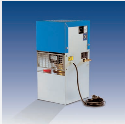
LWK - chłodnica powietrzno-wodna bez agregatu chłodniczego o wydajności chłodzenia 2 lub 2,5 kW, ze zbiornikiem i pompą. Niedrogie rozwiązanie dla zastosowań dla wyższych temperatur wody.
